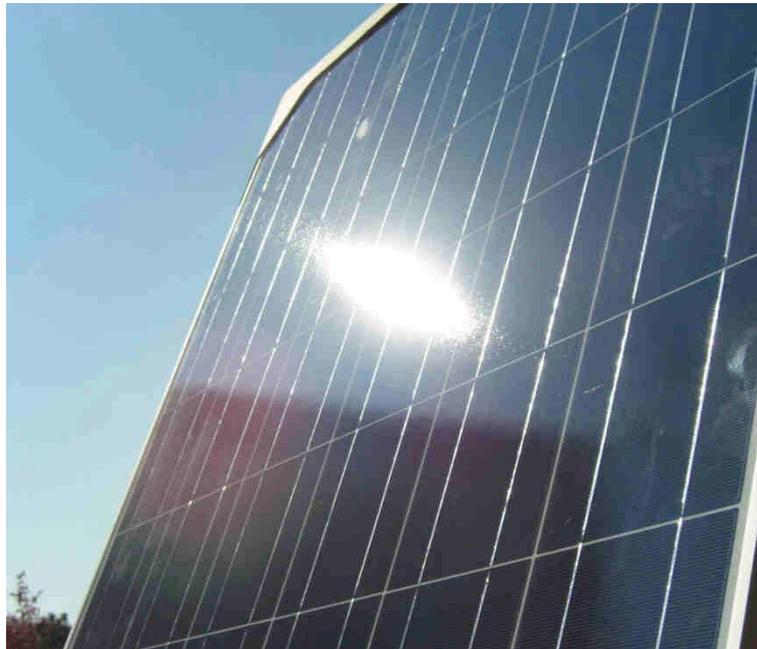
Bündelaufweitung beim Sonnentest eines polykristallinen Moduls,
