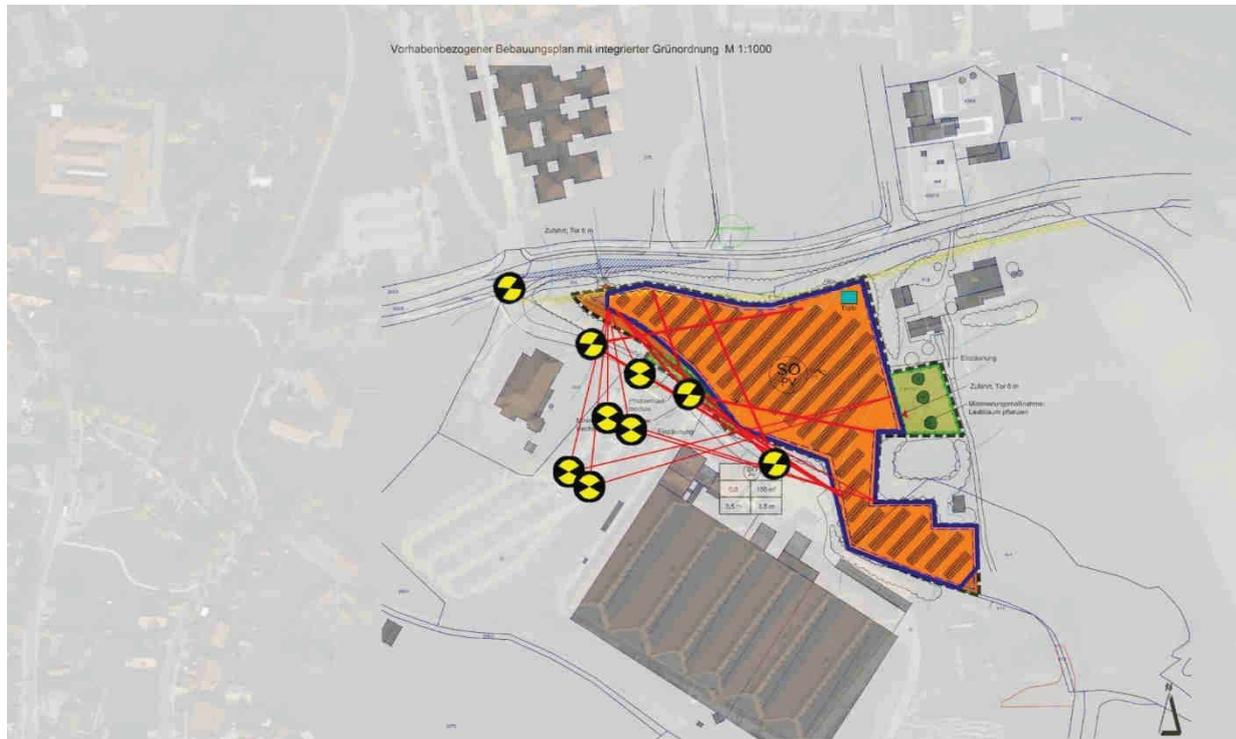
Durch die Ausrichtung der Module auf  $147^\circ$  Südsüdost bei  $18^\circ$  Aufneigung treten in dieser Situation in Richtung der vermerkten Beobachter nur Reflexionen bei tief stehender Sonne in den frühen Morgenstunden kurz nach Sonnenaufgang an den jeweils nördlichen Moduloberflächen auf.
